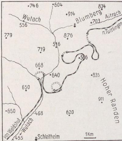
← 139. Ausschnitt aus der Bahnlinie Waldshut a. Rhein—Tuttlingen a. d. Donau. Die Bahn, die die Wasserscheide zwischen Rhein und Donau überschreitet, zeigt, wie selbst Mittelgebirgsbahnen die Geländehindernisse oft durch kühne Bauten, große Schleifen, Tunnel und Kehrtunnel (südl. der Höhe 640) überwinden müssen.
